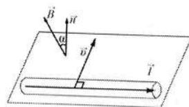
ЭДС индукции в прямом проводнике длиной  $l$ , движущемся со скоростью
